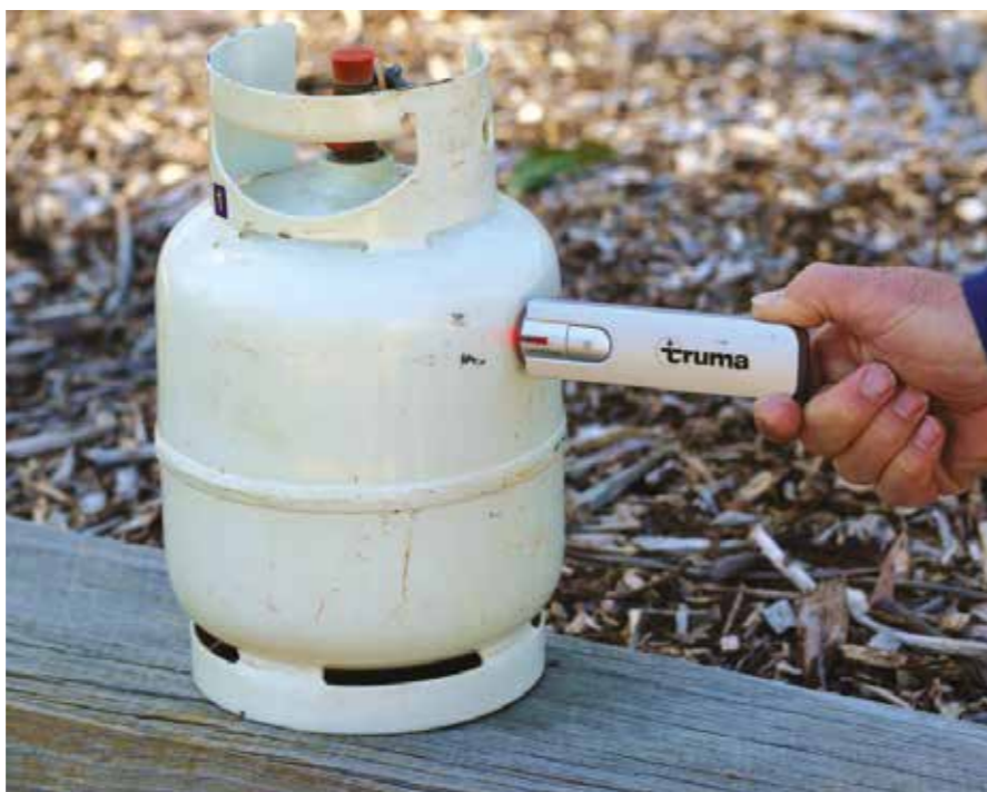
Gas Level Check za ročni vpogled »polnosti« jeklenke.
