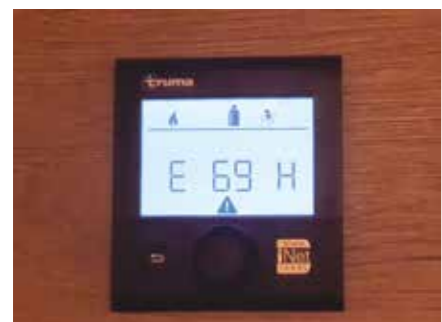
Ena od napak delovanja plinskega grelnika. Ta je povezana s plinom.
