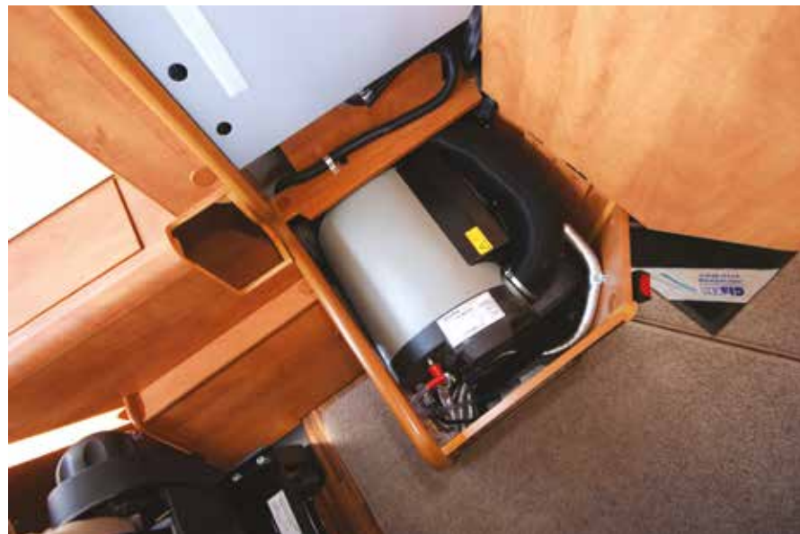
Truma Combi združuje toplozračni grelec in grelnik vode.
