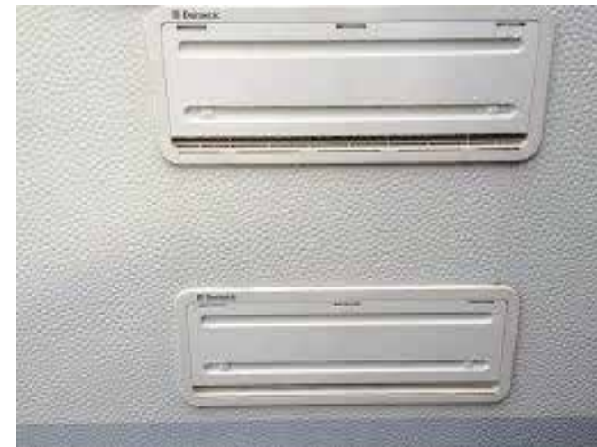
Absorpcijski hladilnik spoznamo že od zunaj – po zračnih rešetkah.
