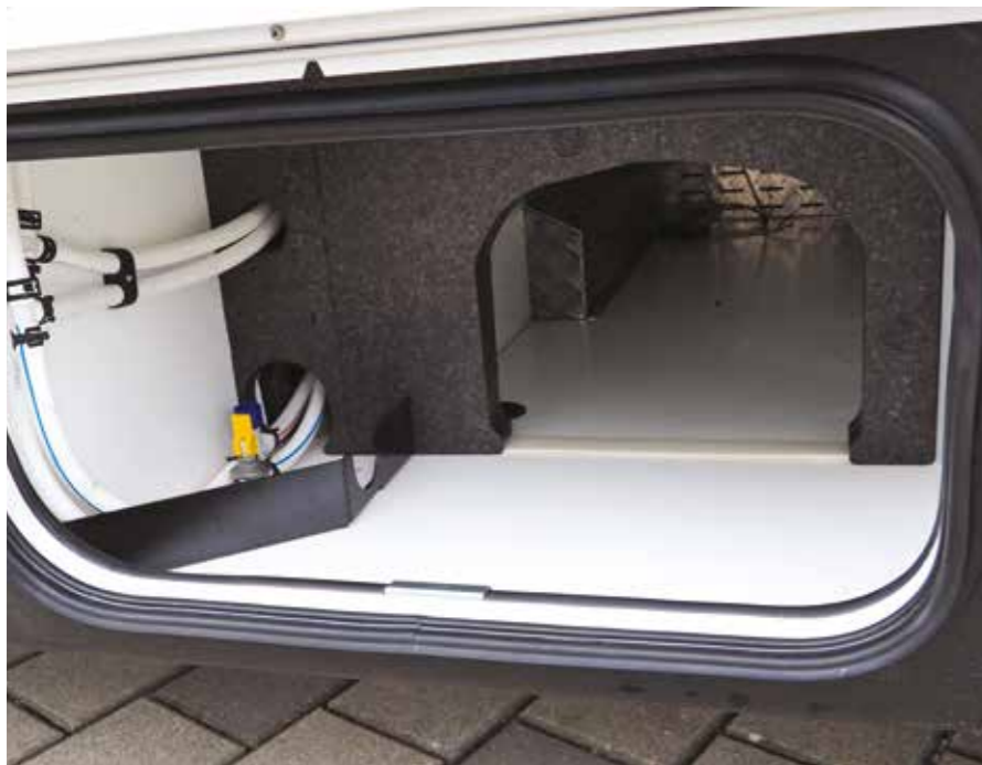
Cevi vodovodnega sistema morajo biti za lažje vzdrževanje kar se da dostopne.
