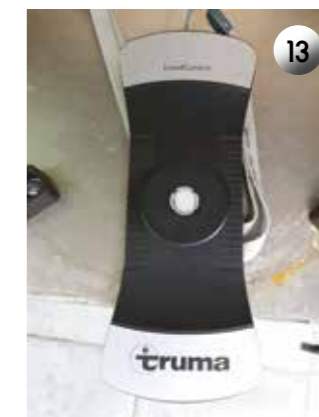
13 Level Control omogoča pregled nad količino plina v jeklenki.
