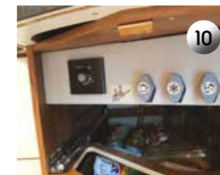
10 Kontrolka omogoča priklop sistema eisex, hkrati pa tudi prikazuje, katera jeklenka je v uporabi.
