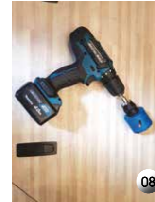
08 Tokrat ne bo šlo brez vrtnja. Mojster si je pomagal z baterijsko vrtačko in kronskim nastavkom.
