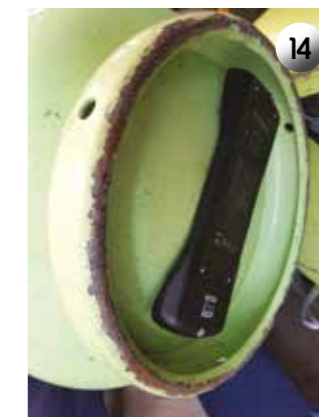
14 Pritrdimo ga pod jeklenko (drži ga magnet, za aluminijaste ali posode iz umetne mase pa so razvili posebne nalepke z magnetno površino).
