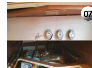
07 Pod pult bo ob ventile plinskega sistema dodan še prikazovalnik.
