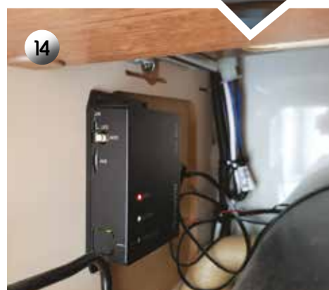
Modul iNet omogoča poveljivost Truminih naprav s pametnimi telefoni in aplikacijo.
