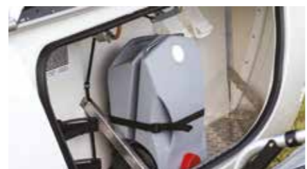
Skladišni prostor ima dovolj prostora za dve jeklenki, posoda za odpadno vodo in zagozde. V njem so predvideli prostor za opcijno rezervno kolo.
