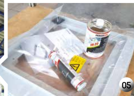
Okvir klimatske naprave se na streho vozila prilepi z lepilno-tesnilno maso.
