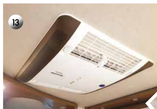
Notranji del klimatske naprave je v Carthagu zaradi stropnih oblog kompaktnih mer in brez osvetlitve.
