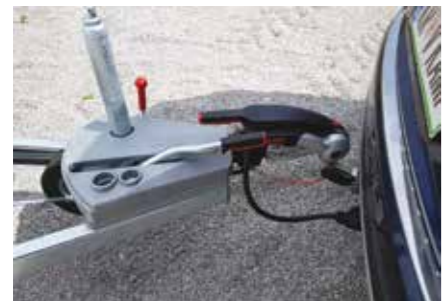
Priklop je znamke Al-Ko, model AKS 2004/3004, ki zagotavlja enostaven priklop.
