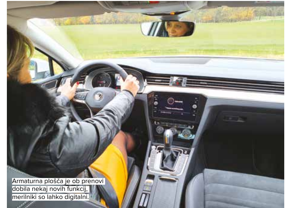
Na vrhu ni več analogne ure, odslej sta tu stikalo vseh smernikov in osvetljen napis Passat.
