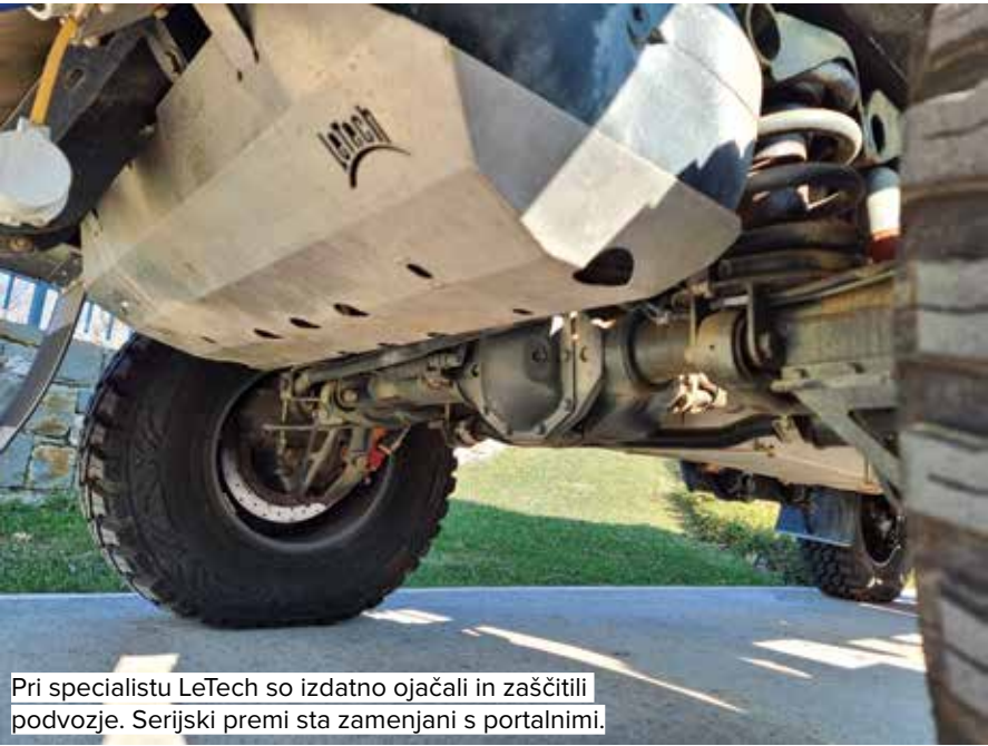
Terenske pnevmatike velikosti 37x12,5 R18 na platiščih Hutchinson Beadlock
